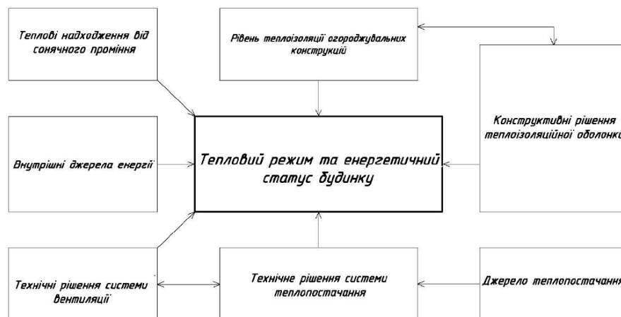
Рис. 1.7 Схема взаємодії основних підсистем будівлі
