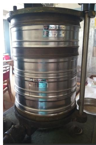
Рис. 2.16. Установка для дослідження дисперсного складу рослинної сировини
