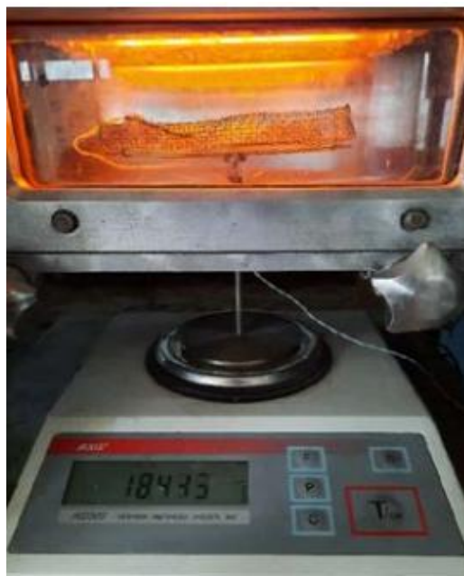
Рис. 2.13. Зовнішній вигляд сушильної камери із застосуванням інфрачервоних ламп з можливістю регулювання теплового потоку від 100 Вт/м 2 до 3800 Вт/м 2
