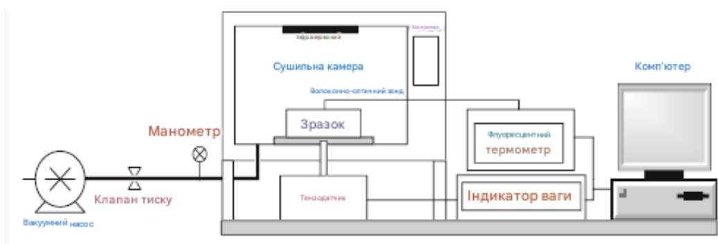
Рис. 1.12. Схема комбінованого мікрохвильово-вакуумно-інфрачервоного методу сушіння [62]
