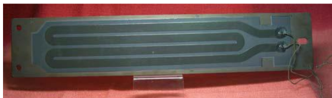
Рис. 4.2. Товстоплівковий нагрівальний елемент тип якого використаний в тунельній сушарці HE 385x75x3мм; U-220 В; P-1000 Вт [96]
