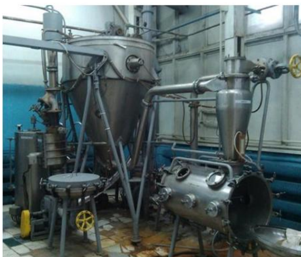
Рис. 1.21. Експериментальний стенд для дослідження теплофізичних параметрів розпилювального зневоднення композиційних рідинних систем (РЦ-1.3) [92]
