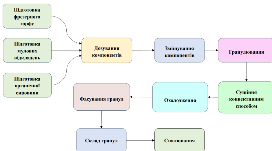
Рис. 1.5. – Технологічна схема отримання композитного палива на основі застарілих мулових відкладень, торфу та органічної сировини [27]
