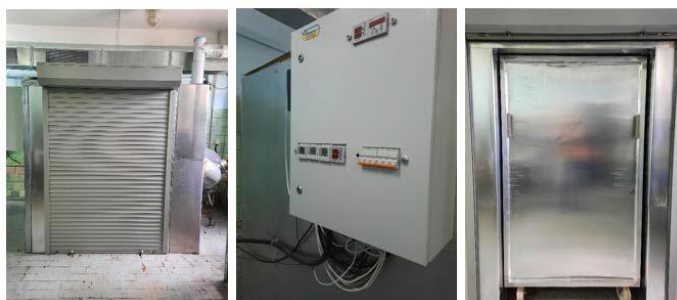
а) б) в) Рис. 24. Енергоефективна дослідно-промислова камерна сушарка: а – вигляд спереду, б – шафа керування, в – вигляд з візками
