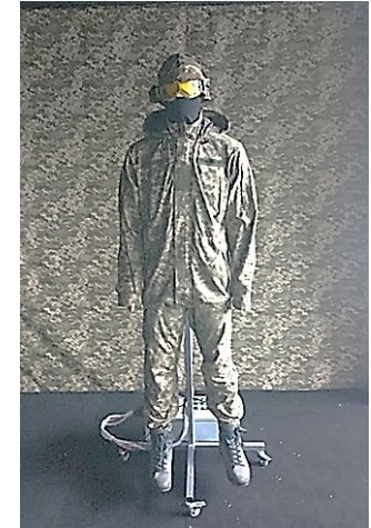
Експериментальний стенд призначений для визначення теплофізичних та термодинамічних показників текстильних виробів в умовах реальної експлуатації
