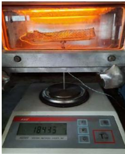
Рис. 3.7. Зовнішній вигляд сушильної камери із застосуванням інфрачервоних ламп з можливістю регулювання теплового потоку від 100 Вт/м 2 до 3800 Вт/м 2
