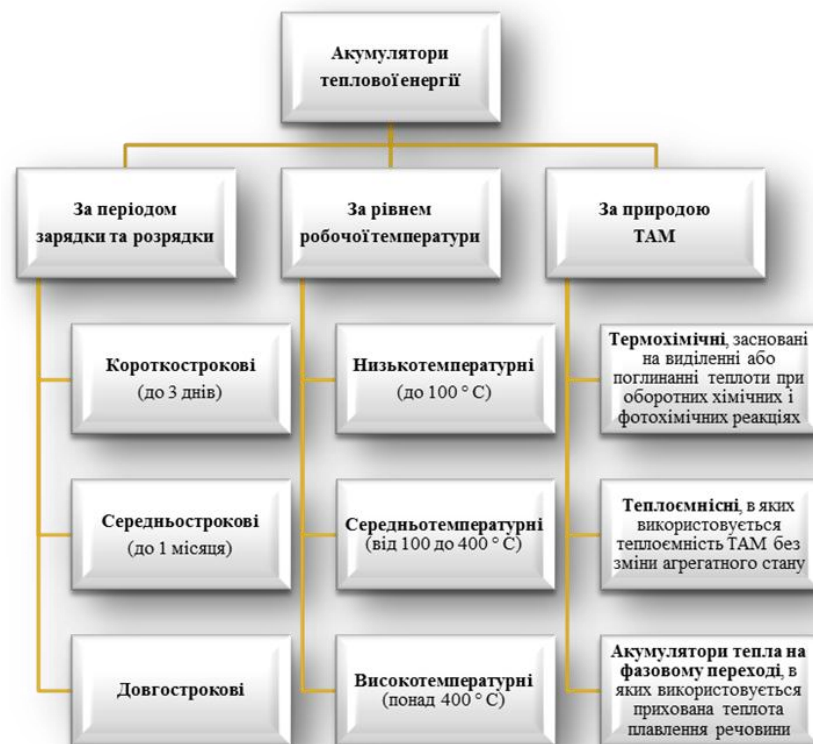
Рис.1.2. Класифікація теплових акумуляторів за робочими характеристиками [5].
