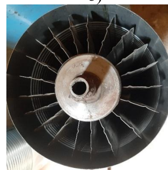
Рис. 7.1.1. Тепловий акумулятор ємнісного типу з РСМ церезином: а) загальний вигляд ТА; б) «теплове ядро» з РСМ; в) порожнє «теплове ядро» [156].
