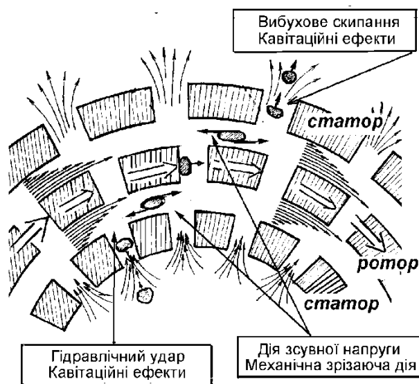
Рис. 2.14. Схематичне зображення динамічних механізмів ДІВЕ, що діють на дисперсію з час проходження через канали РПА.
