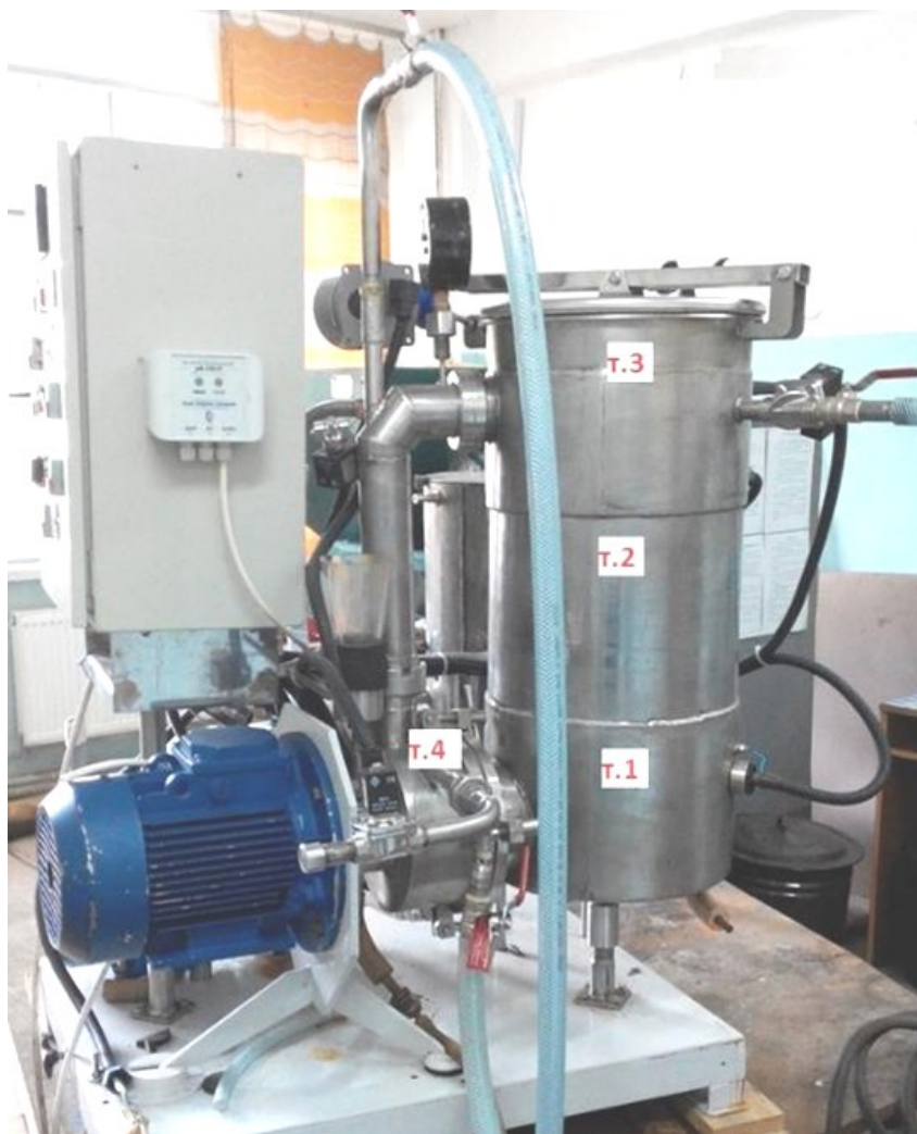
Рис. 7.1. Схема розташування точок вимірювання температури поверхонь дослідного зразка установки нейтралізатора безреагентного
