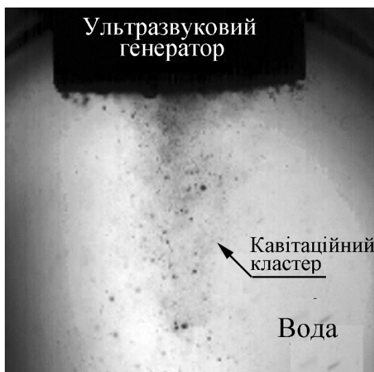
Рис. 1.2. Типовий вигляд кавітаційного кластера, створеного за допомогою УЗ генератора в процесі акустичної кавітації (за даними [11]).
