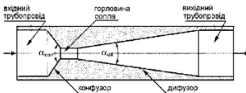
Рис. 1.8. Гідродинамічний кавітаційний реактор типу сопла Вентурі.
