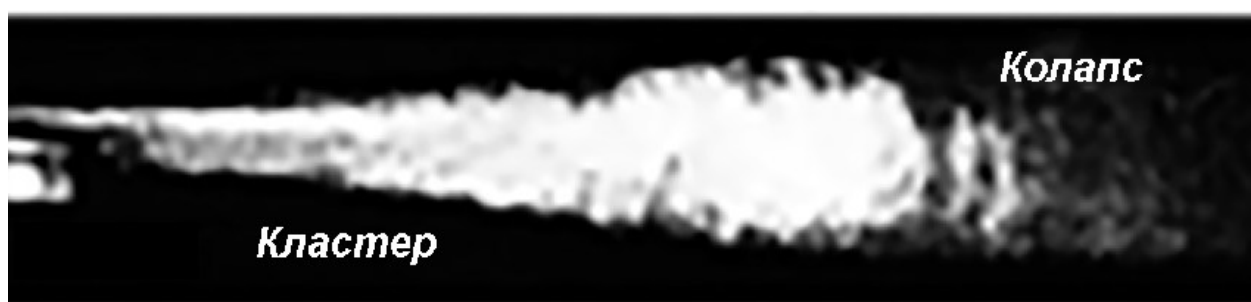
Рис. 1.3. Вигляд кавітаційного кластера, утвореного при проходженні потоку води через звуження каналу (за даними роботи [12]).
