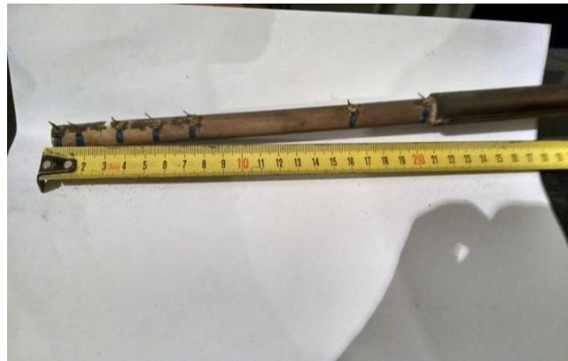
Рис. 2.19 Гребінка термопар, що встановлена безпосередньо над факелом для вимірювання температури в просторі котла
