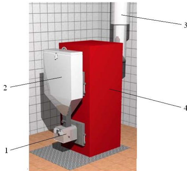
Рис. 2.3 Схема приєднання пелетного пальника до бункера та до котла [48]: 1 – пелетний пальник; 2 – бункер з пелетами; 3 – котел, 4 – труба котла.
