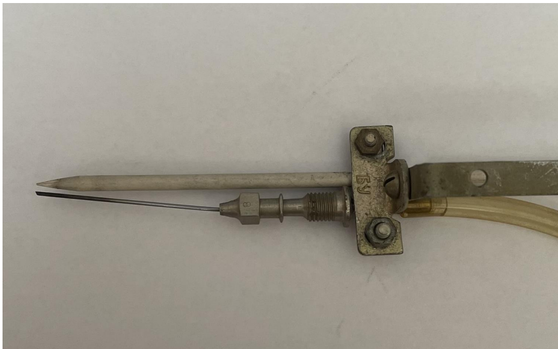
Рисунок 3.1.3 - Система подачі краплинної вологи у фронт полум'я
