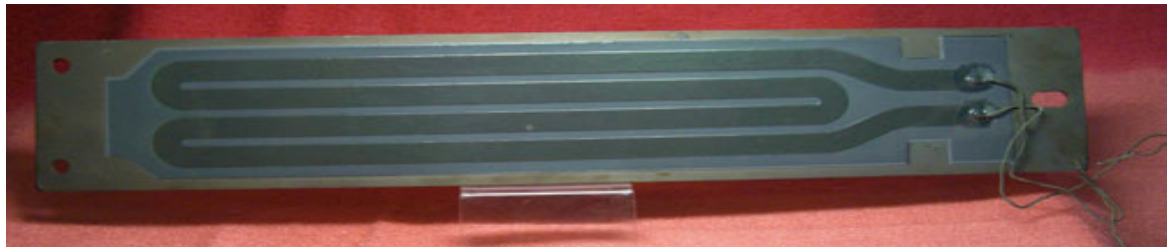
Рис. 5.9. Товстоплівковий нагрівальний елемент тип якого використаний в тунельній сушарці НЕ 385x75x3мм; U-220 В; P-1000 Вт.
