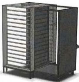
Рис. 1.19. Багаторярусний шафний пристрій для інфрачервоного сушіння.
