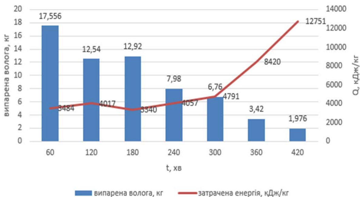
Рис. 4.14 Діаграма погодинних витрат енергії на випарену вологу при завантаженні сушарки на 100% при t = 60\text{ }^{\circ}\text{C} .
