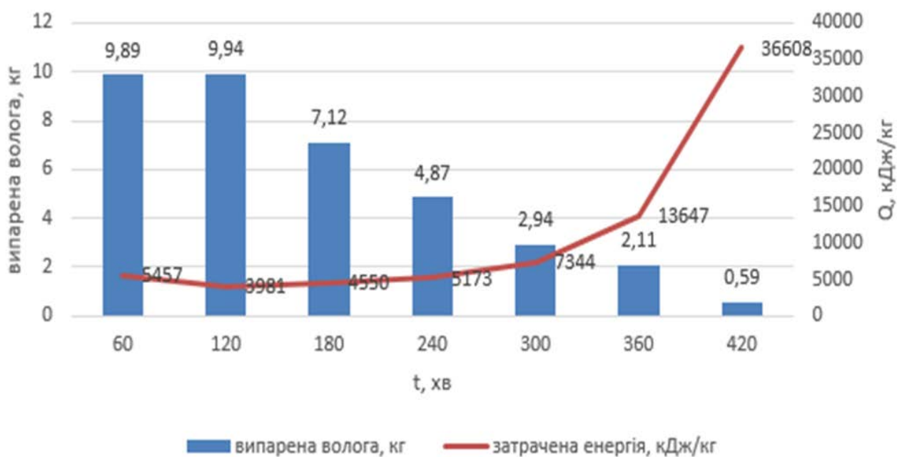
Рис. 4.13 Діаграма погодинних витрат енергії на випарену вологу при завантаженні сушарки на 50% при t = 60\text{ }^{\circ}\text{C} .
