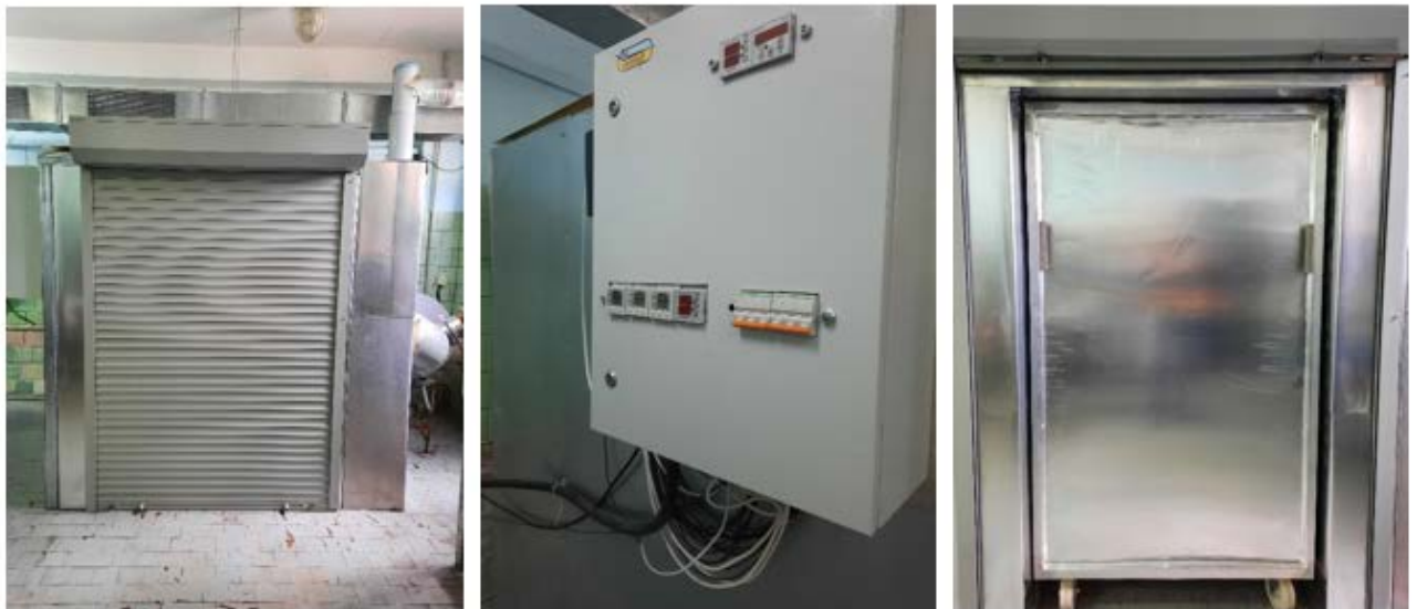
Рис. 4.6. Енергоефективна камерна сушарка для сушіння рослинної сировини. а – вигляд зпереду, б – шафа керування, в – вигляд з візками.
