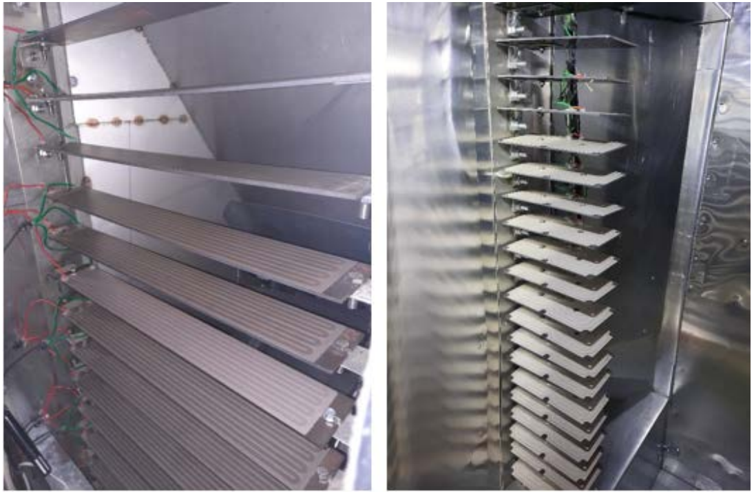
Рис. 4.5. Товстоплівкові нагрівальні елементи встановлені в тунельній сушарці
