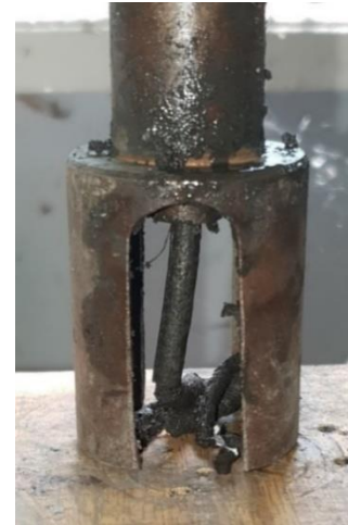
Рис. 2.4. Формування гранул в матриці (тиск формування гранул 2,118 – 2,197 МПа (21,6 – 22,4 кгс/см 2 ))
