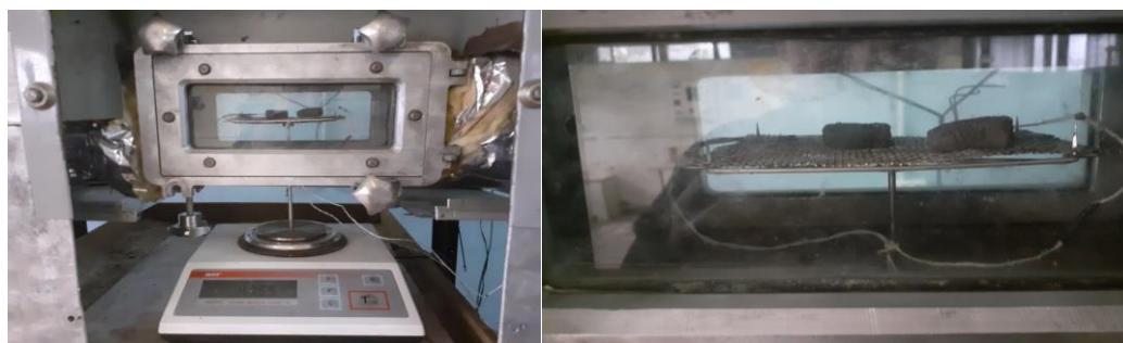
Рис. 2.9. Установка для сушіння муловоторфяних гранул:
