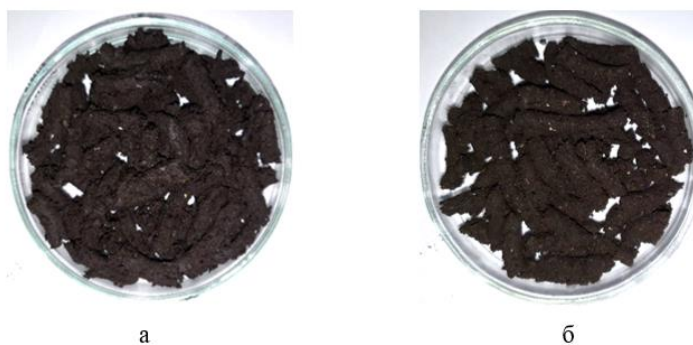
Рис. 3.7. Отримані трьохкомпонентні гранули а) з лузою гречки; б) з тирсою
