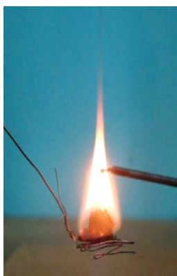
Рис. 2.17. Вимірювання температури факелу
