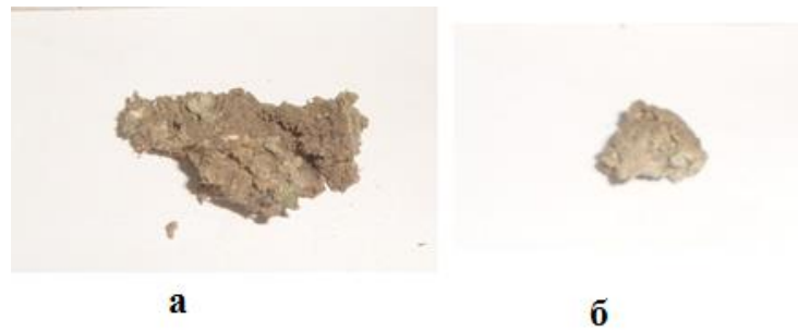
Рис.4.19. Паливо для спалювання на колосниковому тримачі: а – без алюмінієвої фольги; б – зольний залишок
