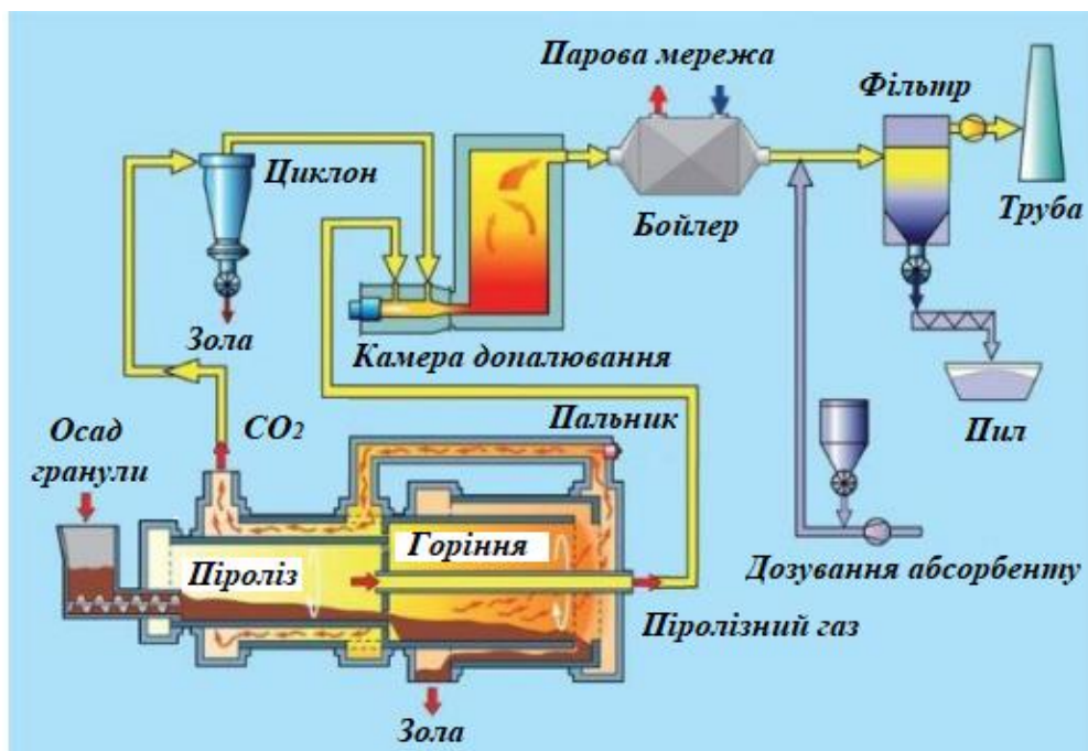
Рис. 1.12. Процес піролізу осадів стічних вод [52]
