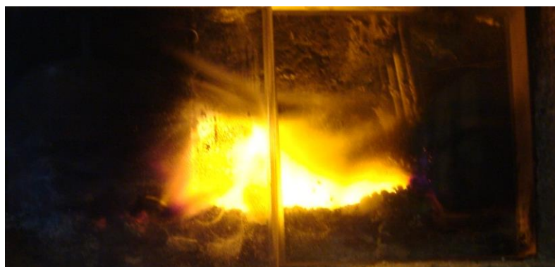
Рис. 4.28. Факел горіння трьохкомпонентних гранул на основі мулових відкладень, торфу та тирси: розрідження 500 Па
