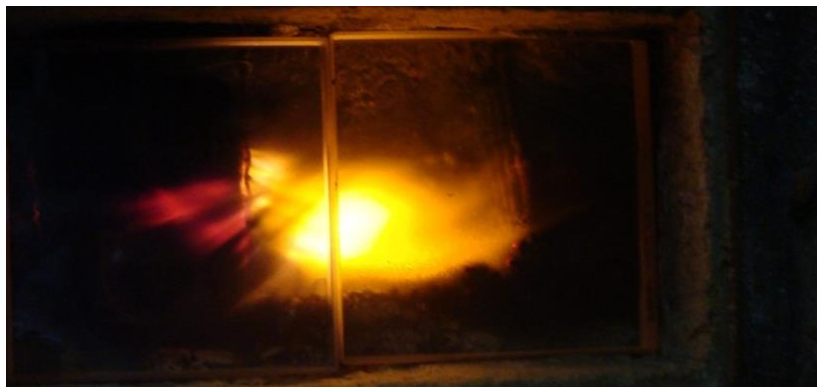
Рис. 4.26. Факел горіння двокомпонентних гранул на основі мулових відкладень та торфу розрідження 250 Па
