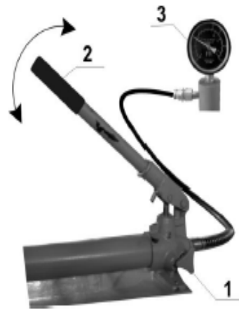
Рис. 2.3. Гідравлічна система пресу для формування гранул: 1 – впускний клапан; 2 – важіль масляного насосу; 3 – манометр
