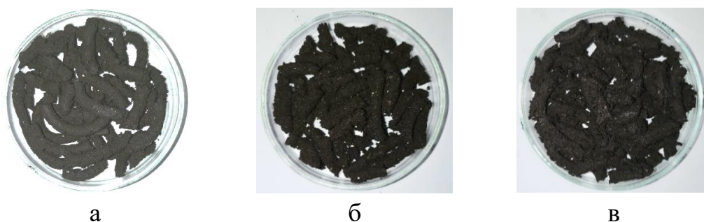
Рис. 3.9. Гранули з двокомпонентного композиту сгранульовані на шнековому механічному пристрої:
