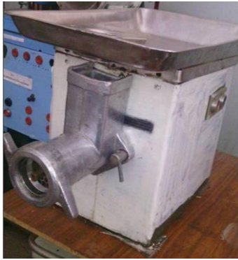
Рис. 2.5. Шнековий механічний пристрій для формування гранул:
