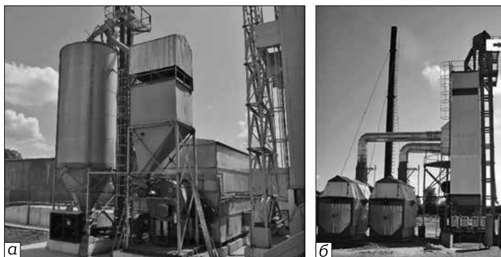
Рис. 11.25. Зерносушарки на біомасі: а – теплогенератор компанії TEFF (м. Одеса) потужністю 6 МВт до зерносушарки Vopfanti; б – зерносушильний комплекс КС-16 компанії «Бриг» Джерело: ( http://www.brig-zerno.com.ua/produktsiya/zernosushilnoe-oborudovanie-na-biomasse/zernosushil-nyj-kompleks-ks-16 )
