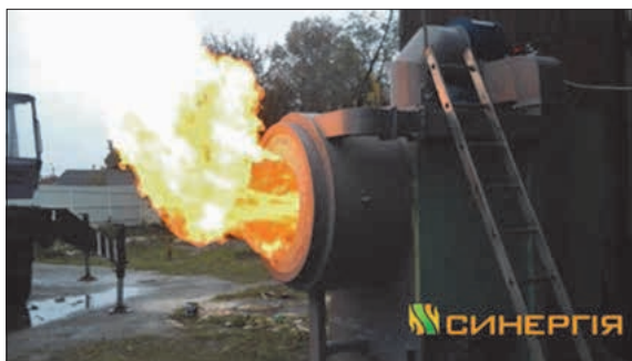
Рис. 11.26. Циклонний принцип спалювання сипких палив
