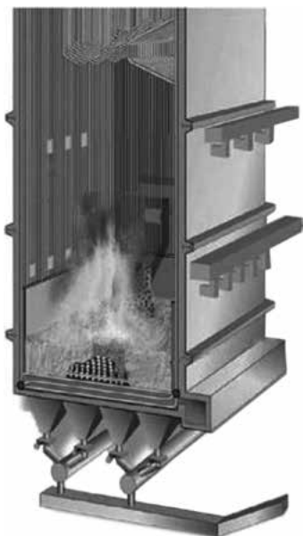
Рис. 7.20. Котел з КШ
