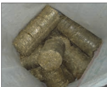
Брикетки з соломи, екструдерне пресування
