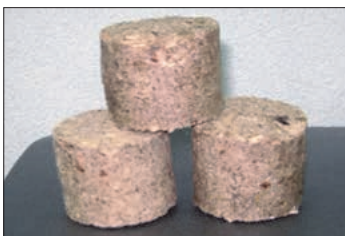
Брикетки з деревини, отримані на ударно-механічному пресі
