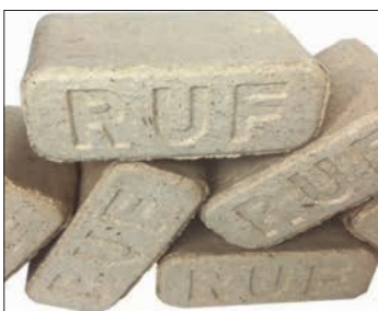
Брикетки з деревини типу RUF, отримані на гідравлічному пресі, пресування в двох напрямках
