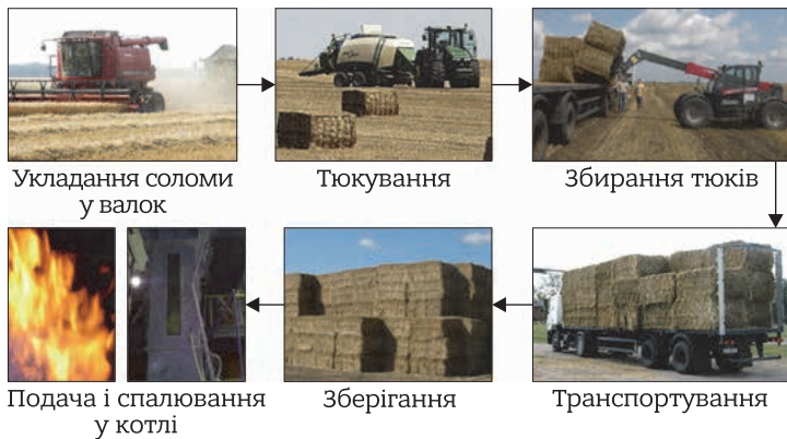
Рис. 4.1. Схема організації виробничого процесу заготівлі та використання соломи
