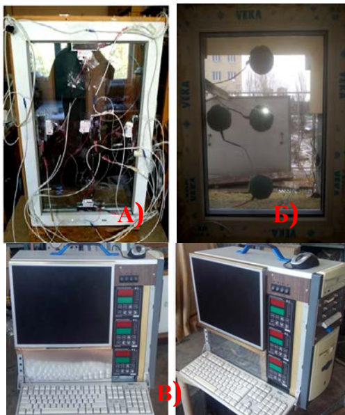
Рис. 1. Експериментальна установка для дослідження теплопередачі через склопакет з електрообігрівом (а-б) та 48-канальний блок теплової реєстрації на основі напівпровідникових сенсорів теплового потоку (в)
