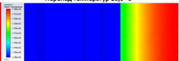
Випромінювач під кутом, зі сторони рівного плавника Перепад температур 10,6^\circ\text{C}
