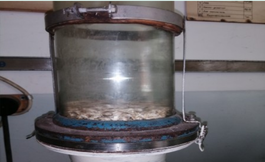
Висота шару та його стан в залежності від швидкості теплоносія
