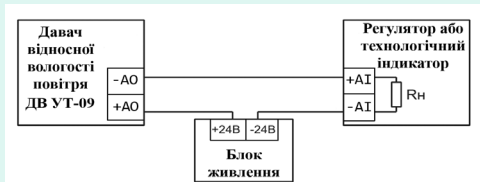
Схема підключення датчика ДВ УТ-09
