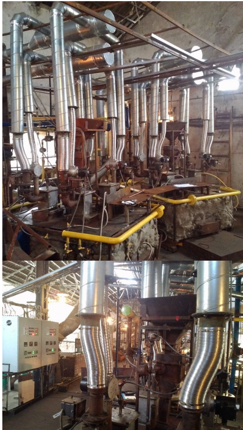
Рисунок 7. 4 – Фото інноваційної модульної установки виробництва БСВТ Питомі енергетичні показники технологічного процесу: а) 2,1-2,5 ст. м 3 природного газу/кг готової продукції; б) 2,2-2,4 кВт·год/кг готової продукції. Економічний ефект від провадження однієї установки 1,848 млн. грн./рік.
