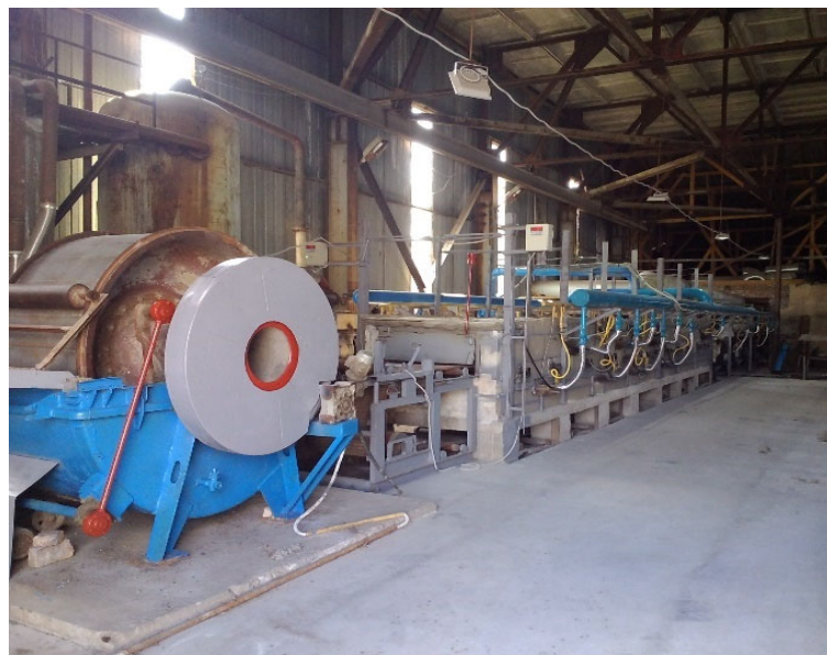
Рисунок 7. 12 – Модернізована конвеєрна лінія виробництва базальто-бентонітових картонів.
