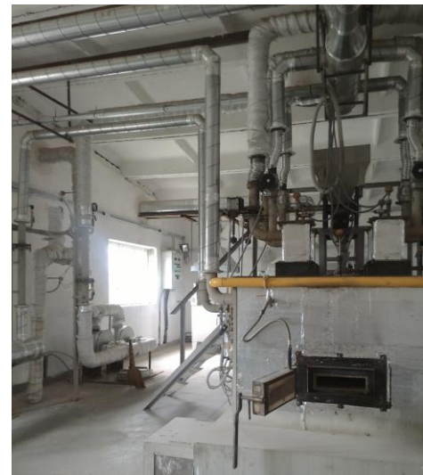
Рис. 50. Дослідно-промисловий зразок агрегату ББВ: продукція безперервне БВ 8-13(μm)/15-20(μm); продуктивність 160 (кг/добу).
