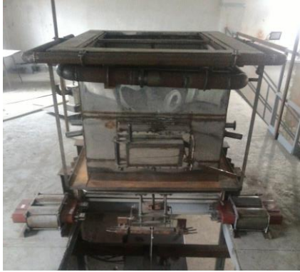
Рис. 49. Дослідно-промисловий зразок КТ: маса апарата 750 (кг); габаритні розміри (Д/Ш/В) 1320/960/920 (мм).
