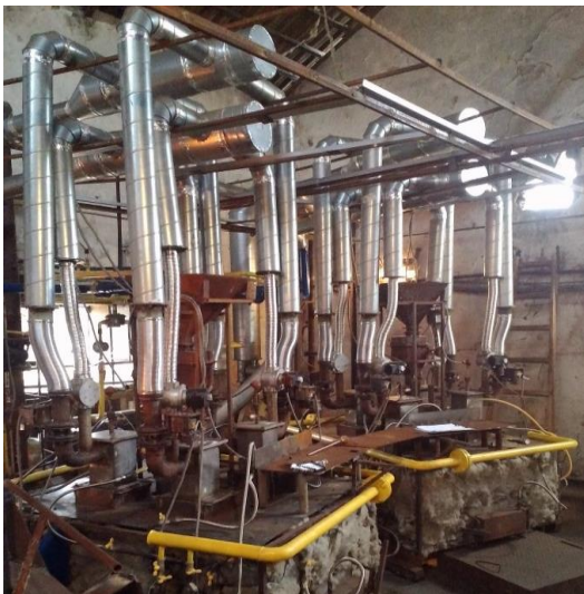
Рис. 51. Дослідно-промисловий зразок агрегату БСТВ: продукція штапельне БВ 0,8-1,2(μm); продуктивність 700 (кг/добу).
