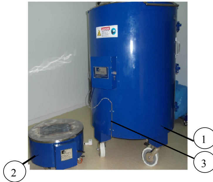
Рис. 1.9. Установа для нагріву та плавлення з покриттям ємності нагрівальним елементом (виробник – Fabtech Technologies International Pvt. Ltd., Індія): 1 – верхній і середній нагрівальні елементи; 2 – нижній нагрівальний елемент; 3 – температурний датчик.
