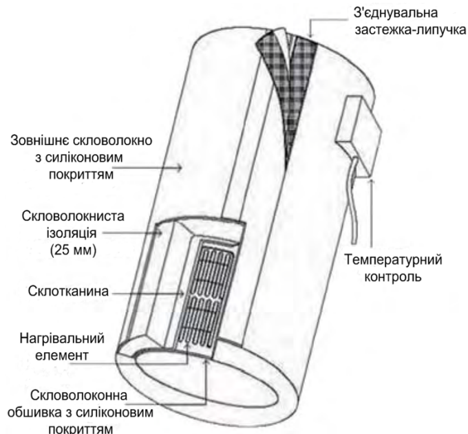
Рис. 1.5. Повне покриття ємності нагрівальним елементом
