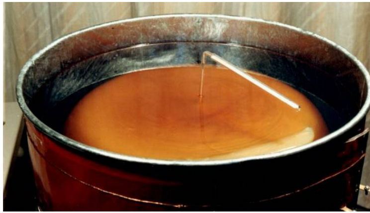
Рис. 1.8 – Процес плавлення вазеліну в ємності з використанням стрічкових електронагрівачів
