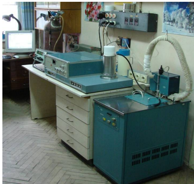
Рис. 2.6. Калориметричний комплекс на базі диференціального скандувального мікрокалориметра ДСМ-2М
