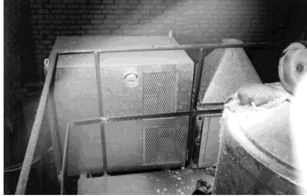
Рис. 6.22. Конденсаційний осушувач повітря для пристрою сушки відходів ПЕТФ в лінії гранулювання термопластів ЛГТВ-150
