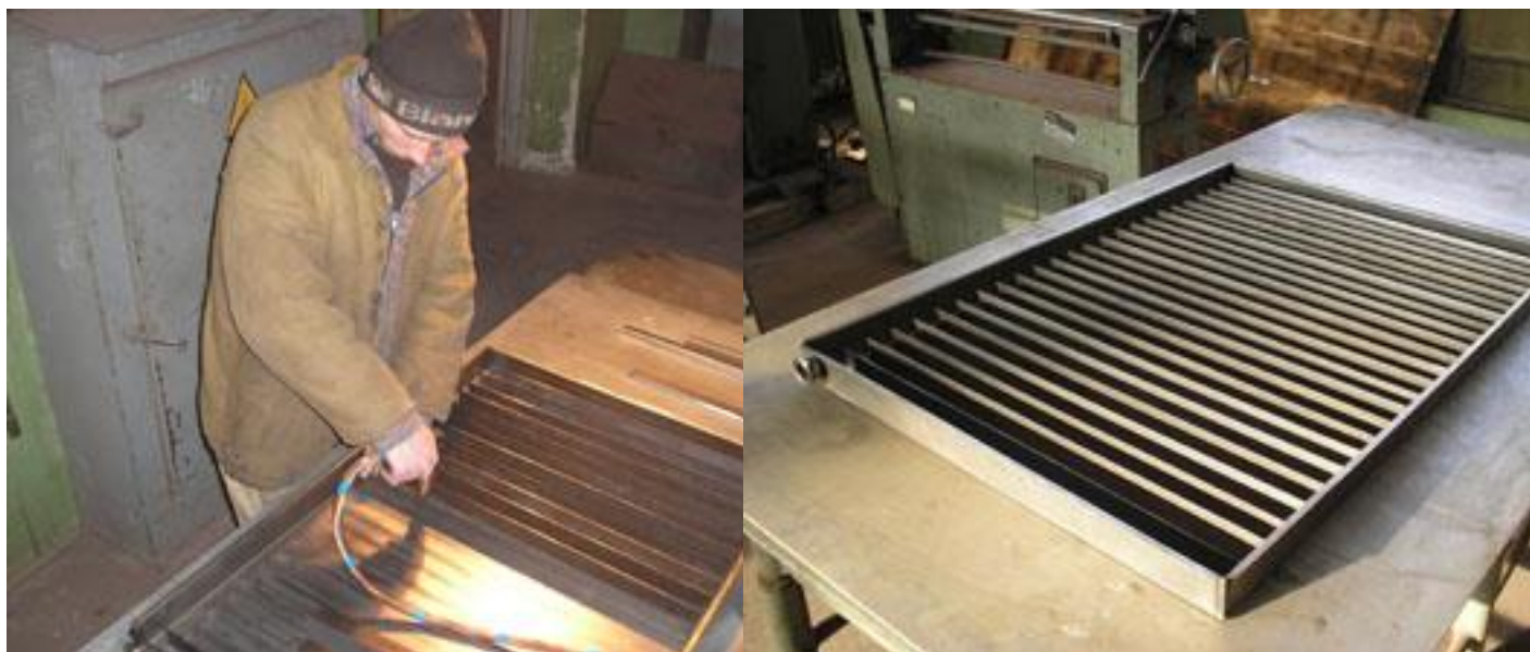
Рис. 4.8. Етапи виготовлення генератора-адсорбера з горловиною для засипки та вивантаження сорбенту
