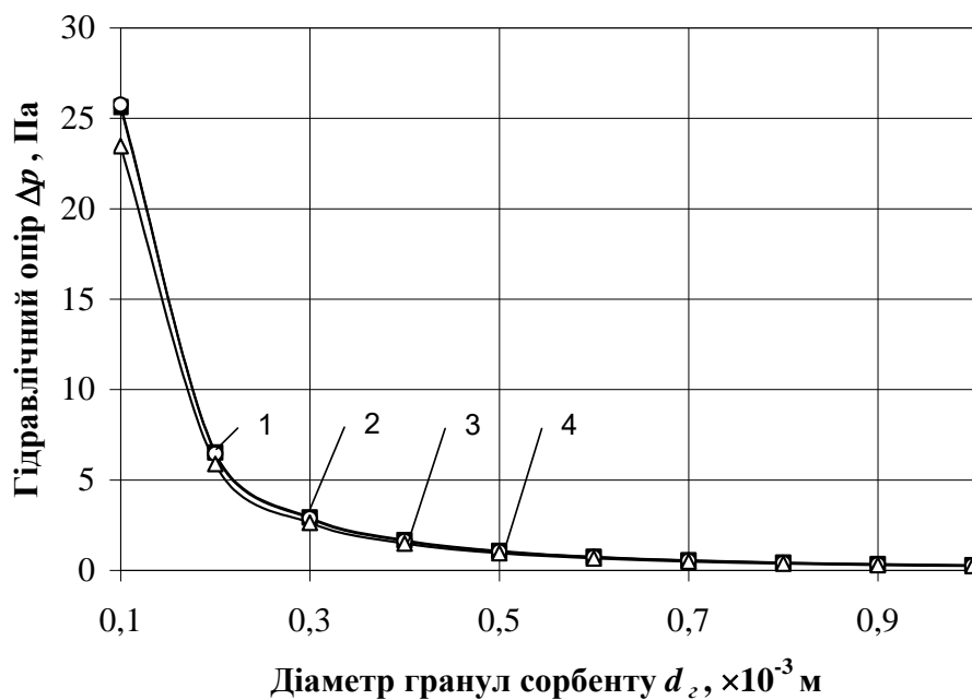
Рис. 4.35. Результати розрахунку гідравлічного опору шару сорбенту адсорбера-десорбера:
