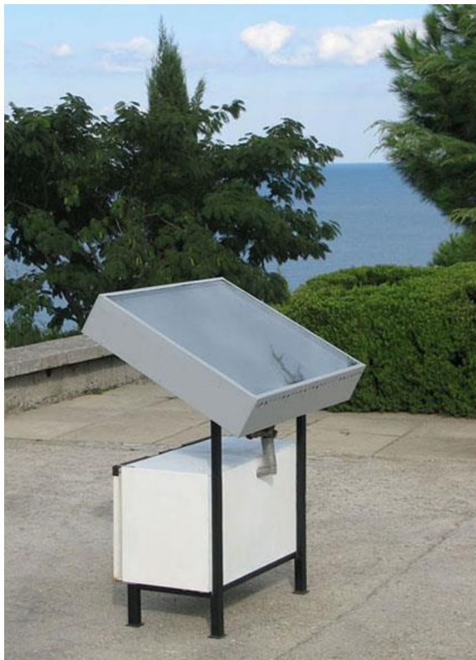
Рис. 4.12. Експериментальний сонячний адсорбційний холодильник на місці проведення натурних випробувань
