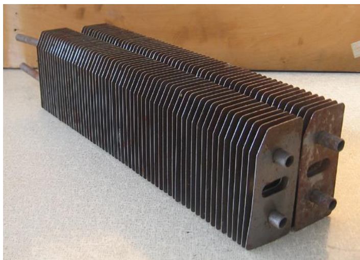
Рис. 4.32. Елементи теплообмінної поверхні сорбційної касети
