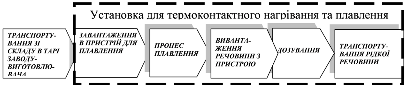
Рис. 13. Технологічна схема прискороного нагрівання та плавлення вуглеводневих сумішей
