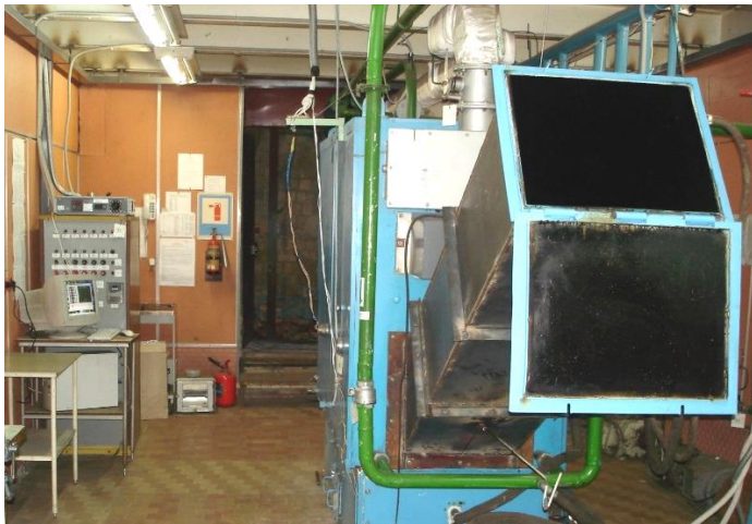
Рис. 4.21. Загальний вигляд реконструйованого експериментального стенду з лотковим топковим пристроєм.
