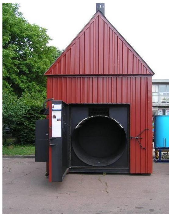
Рис. 1.18. Теплогенератори виробництва ВАТ „ПТЕМ” для спалювання великих тюків соломи.
