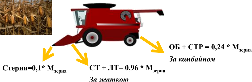
Рис. 3.5. Орієнтовні потоки рослинних решток при збиранні кукурудзи зернозбиральним комбайном.
