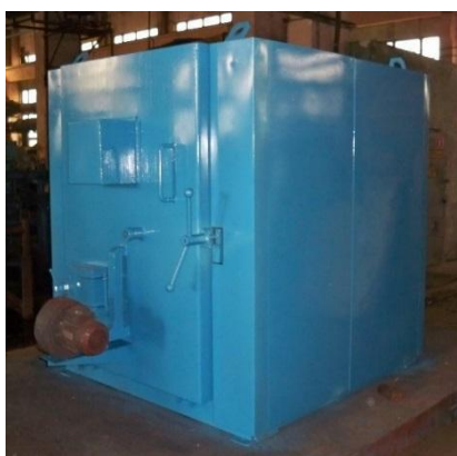
Рис. 4.20. Соломоспалювальний котел потужністю 100 кВт.
