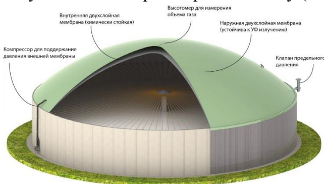
Рис. 3.19. Газгольдер гнучкий, суміщений з реактором
