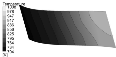
Рис. 2. Температурний стан лопатки завихрювача робочого пальника із 8 лопатками.
