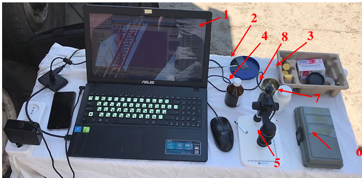
Рис. 4.26. Комплекс для вимірювання, фото- та відеофіксації крапель дисперсного потоку: 1 – персональний комп'ютер із програмним забезпеченням для системи вимірювання, фото- та відеофіксації; 2, 6 – предметне скло із нанесеним імерсійним середовищем; 3 – набір форсунок типу ФМТ; 4 – спирт для протирання предметного скла; 5 – електронний мікроскоп; 7 – літол; 8 – моторне масло.
