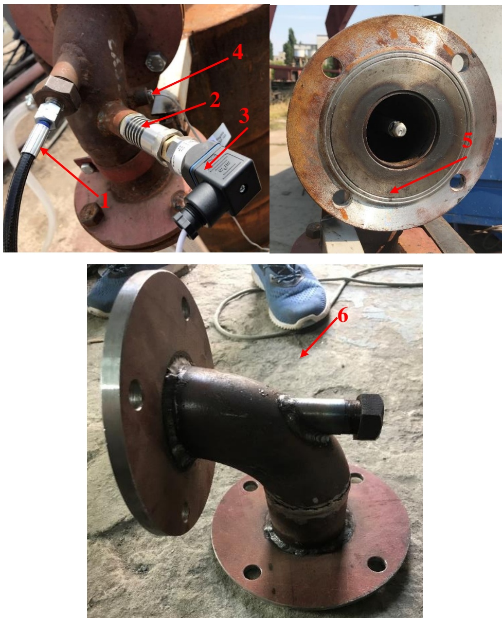
Рис. 4.6. Приймальна камера: а) – встановлення датчиків і системи вприскування; б) – вид на форсунку; в) – загальний вид; 1 – система вприскування води; 2 – радіатор (холодильник) для датчика вимірювання тиску; 3 – датчик вимірювання тиску; 4 – датчик вимірювання температури; 5 – форсунка; 6 – патрубок для монтажу трубки подачі води.
