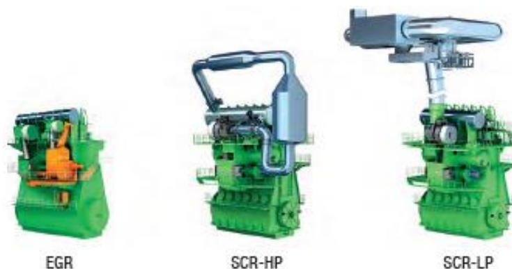
Рис. 1.11. Розташування систем EGR і SCR на малообертовому двигуні фірми MAN
