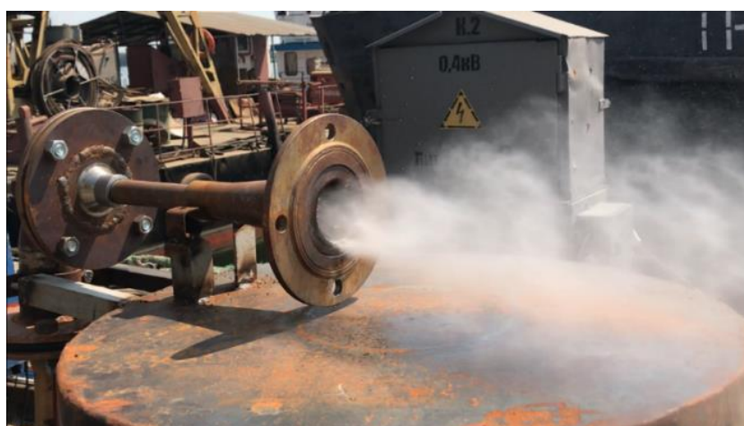
Рис. 4.42. Фото уловлених крапель (а) та зовнішній вигляд потоку на виході з аеротермопресора (б): аеротермопресор з випаровуванням; форсунка ФМТ-100,0; G_w = 0,0407 кг/с; збільшення вимірювальної системи електронного мікроскопу 300X.
