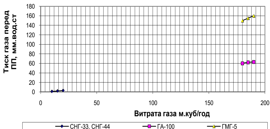
Рис.7.11 Порівнянн режимів розпалу (тиск газу і витрати газу) ПП
