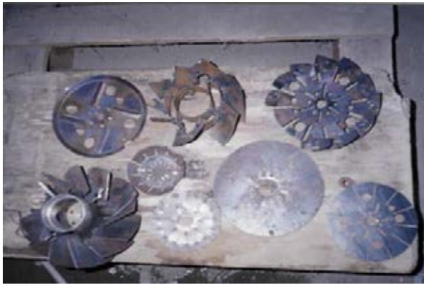
Рис 1.20 Металеві завихрювачі, що використовує фірма DAVA.
