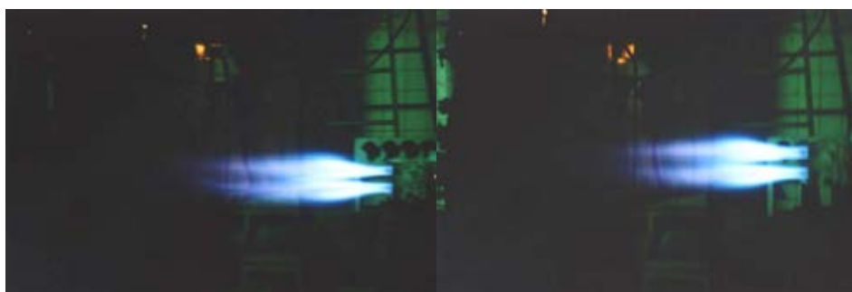
Рис.5.11 Розвиток факела в струменево-нішевому пальниковому пристрої при зміні режимів роботи. W_{п}=16 м/с
