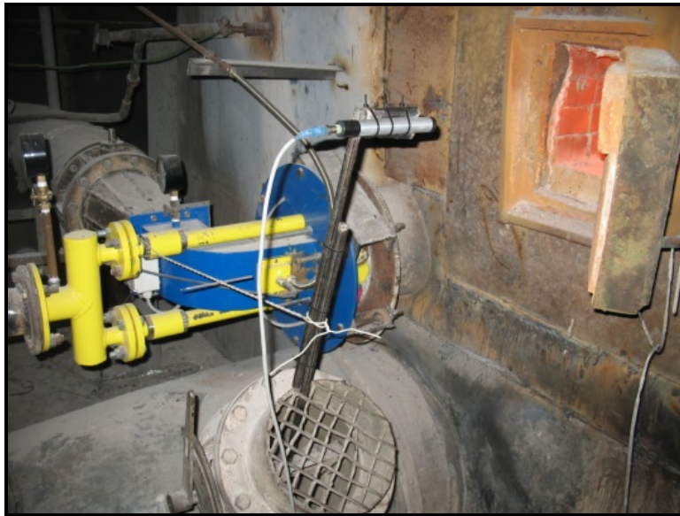
Рис. 7.20 Пальниковий пристрій СНТ з лазерним пірометром на посту сушки ковшів
