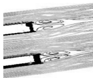
Рис. 3.19 Модель потоку за стабілізатором плоского типу
