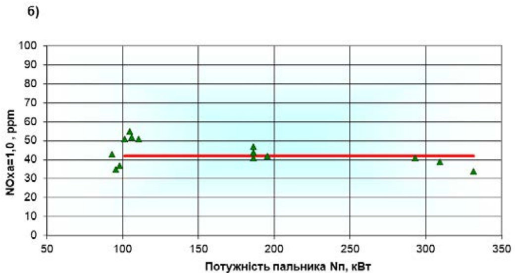
Рис. 7.4 Концентрація CO(a) і NOx (б), приведена до \alpha=1,0 у відхідних газах в залежності від теплової потужності
