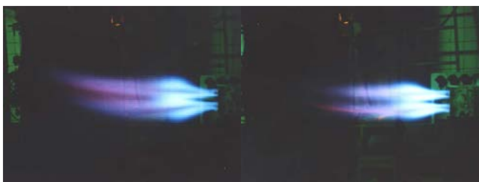
Рис.5.10 Розвиток факела в струменево-нішевому пальниковому пристрої при зміні режимів роботи. W_{п}=11 м/с
