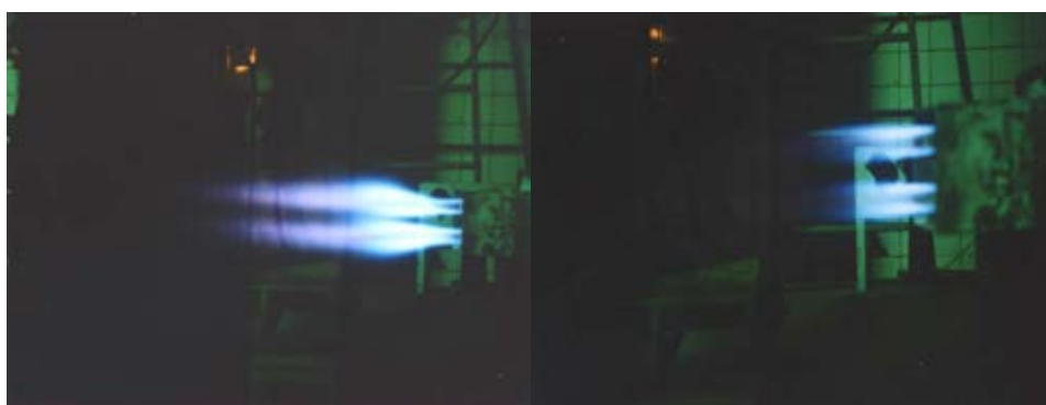
Рис.5.11 Розвиток факела в струменево-нішевому пальниковому пристрої при зміні режимів роботи. W_{п}=16 м/с
