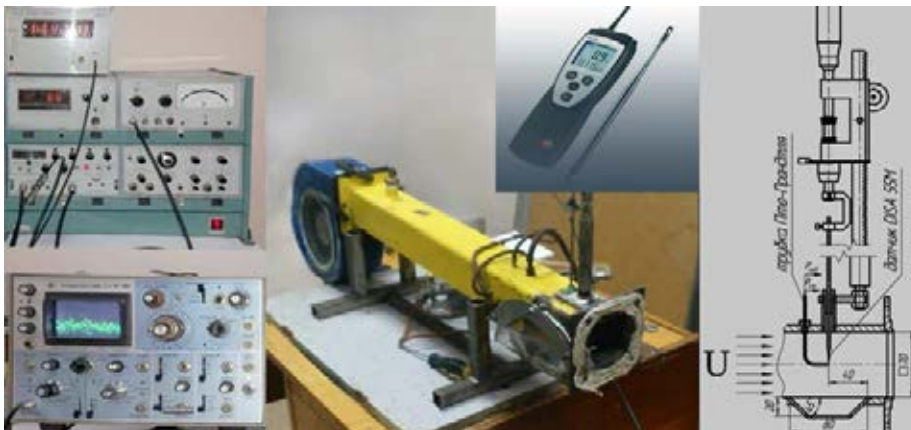
Рис. 2.3 Аеродинамічний стенд вимірювальною апаратурою
