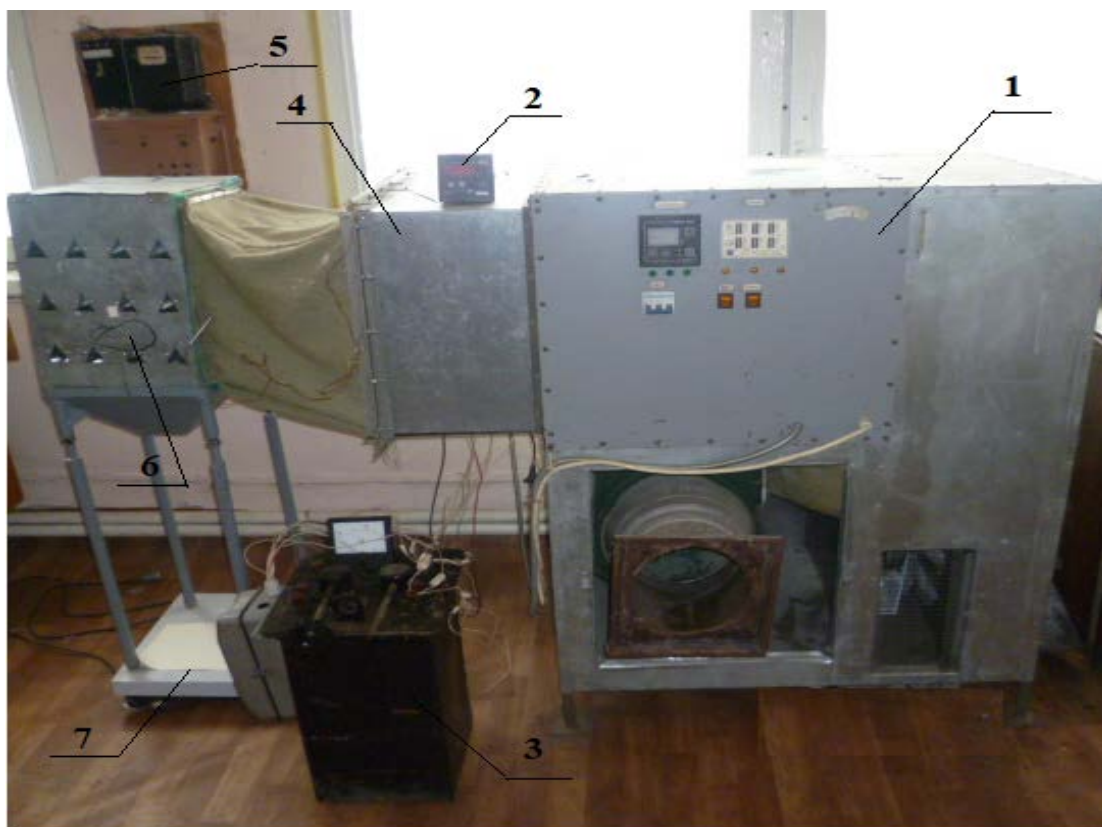
Рис. 4.6. Сушильний стенд шахтного типу із тепловим насосом з блоком електричних нагрівачів:
