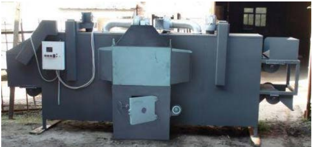
Рис. 1.19. Однострічкова сушарка з твердопаливним котлом для сушіння насіння овочевих культур
