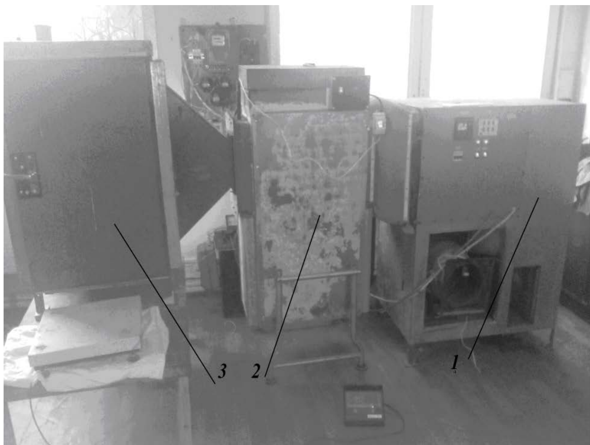
Рис. 4.9. Сушильний стенд камерного типу із тепловим насосом для сушіння насіння олійних та овочевих культур (соя, гарбуз):
