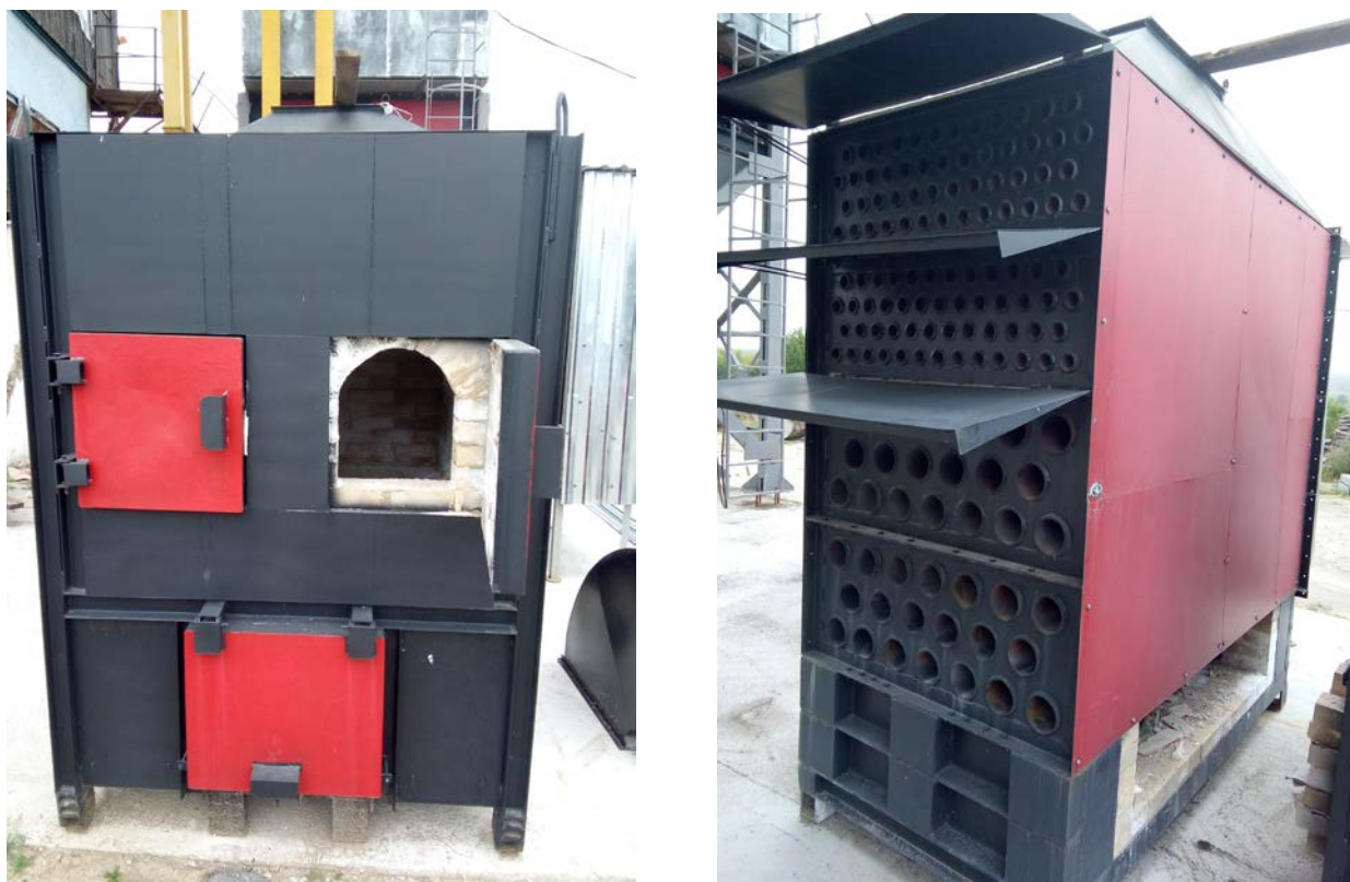
Рис. 6.15. Виробництво твердопаливного котла та чотирьохсекційного теплообмінника
