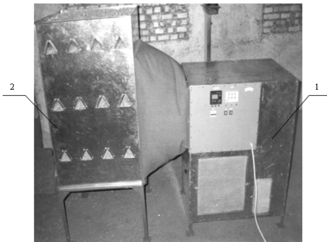
Рис. 6.13. Зерносушарка шахтного типу ТНЗШ – 0,5 на теплонасосних теплогенераторах для сушіння насіння зернових, олійних та технічних культур.
