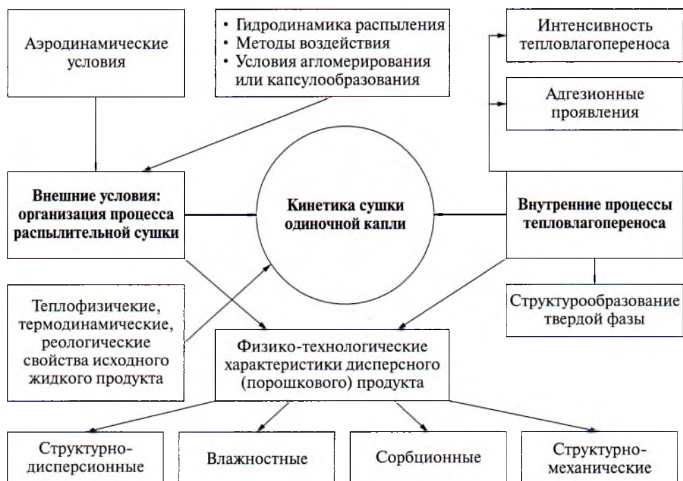
Рис. 1. Взаимосвязь внешних и внутренних процессов тепло- и массообмена в камере распылительной сушилки на кинетику обезвоживания капли и на характеристики конечного порошкового продукта
