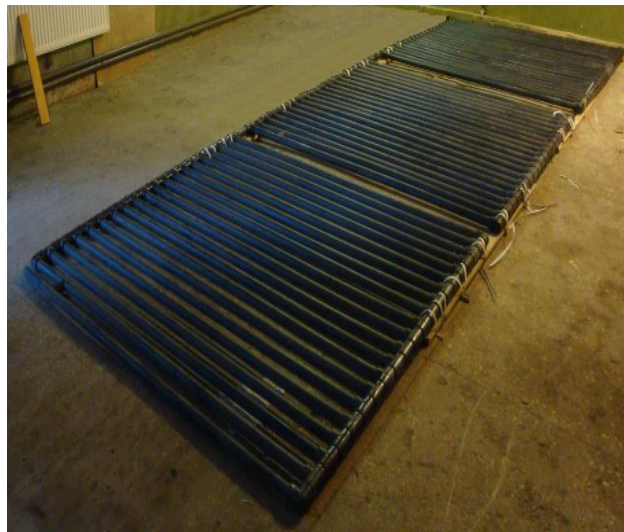
Рис. 7.21. Теплообмінники типу «ґрунт – рідина»
