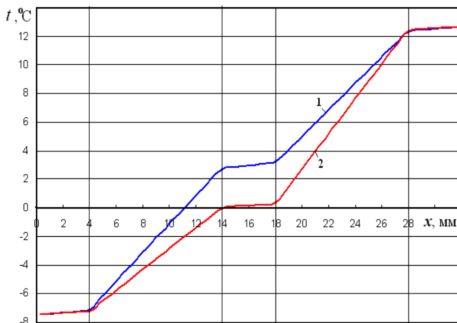
Рис. 3.3.1.1. Розподіл температури по ширині двокамерного склопакету (1), та по ширині двокамерного склопакету з одним низькоемісіним покриттям (2).
