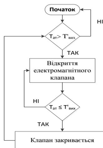
Рис. 3.3. Алгоритми роботи сонячного колектора
