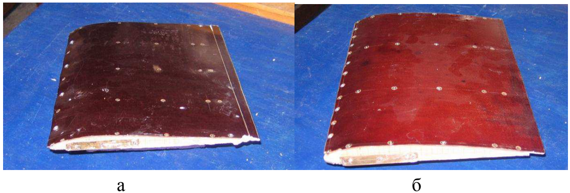
Рисунок 2.11 – Сменные криволинейные профили для обеспечения продольного отрицательного градиента давления (ускорения потока). а, б – профили № 1 и № 2, соответственно.
