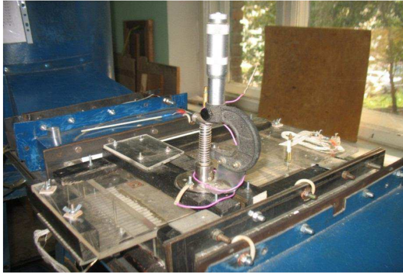
Рисунок 2.4 – Общий вид экспериментального участка с координатным устройством для измерения профиля полного давления.
